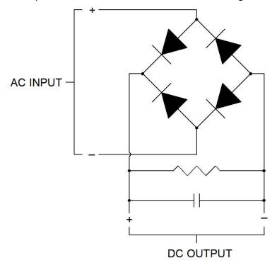
Figure 4.1.2 Full Wave Rectifier Circuit
